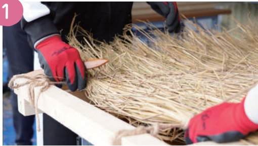
わらを200cm×90cmのシート状に編みます。今回は、約120枚を編みました。
