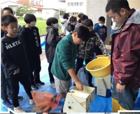
回転している鉄の網で、屑米と分別します。
