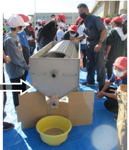
回転している鉄の網で、屑米と分別します。
